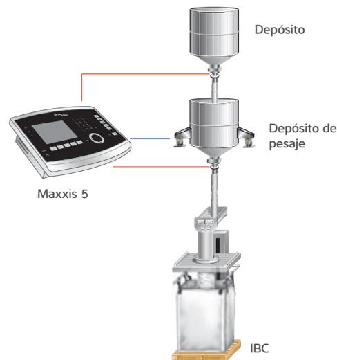
Llenado monocomponente con depósito
